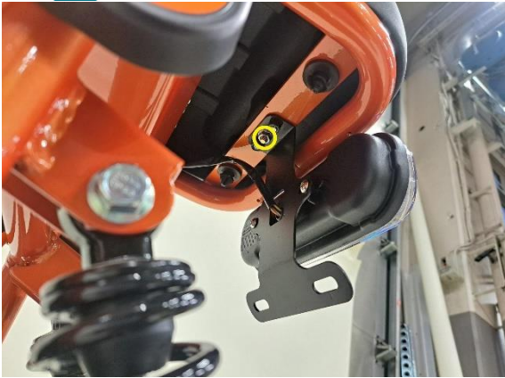
Irrota istuimen kiinnitysmutteri (kiintoavain 10 mm).
